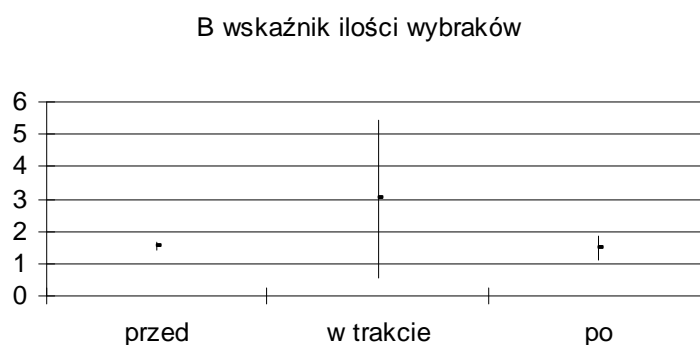
Rysunek 4 Zmiany ilości wybraków określona wskaźnikiem B przed, w trakcie i po wdrożeniu SZJ wg. ISO/TS 16949, pionowe linie przedstawiają długość przedziałów ufności wartości średniej wskaźnika B
